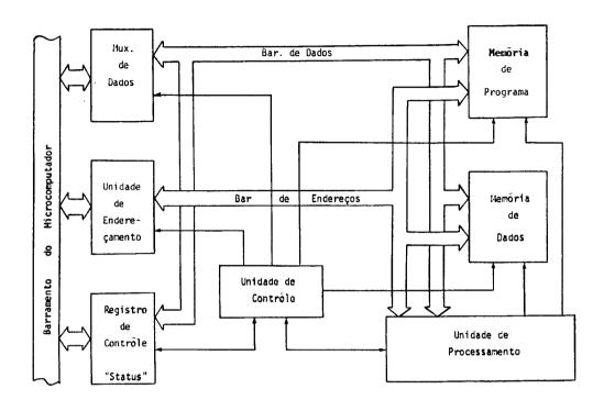
Fig. 3.1 - Diagrama em blocos do PN25
