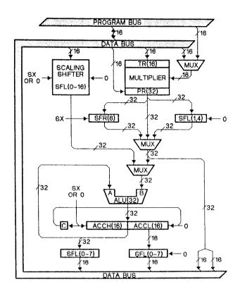
Fig. 3.2 - Unidade de processamento do TMS320C25
