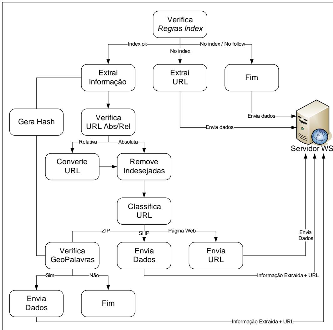
Figura 3-9 – Fluxo tarefas realizadas durante a análise sintática.
