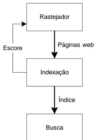
Figura 3-14 – Estrutura em cascata de um mecanismo de busca.
