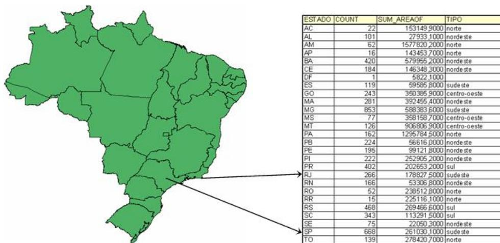
Figura 2-14 – Representação gráfica do arquivo *shape* com o respectivo arquivo dBase.
