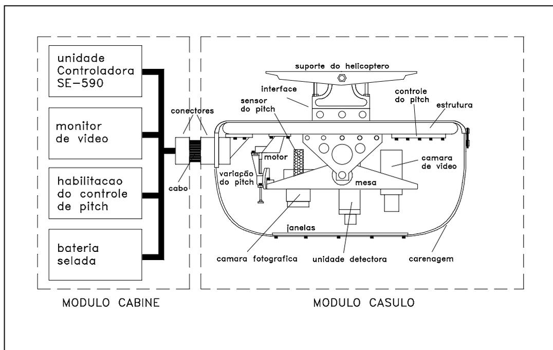
Figura 3. O Sistema de Aquisição de Dados Aerotransportado
