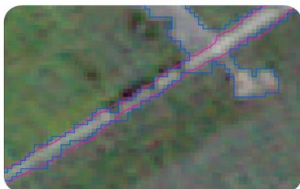
**Figura 5: Exemplo de diferença das suavidades de contorno entre a segmentação automática e a segmentação referência, para a classe Estrada, tomando como base a imagem Rapideye.**
