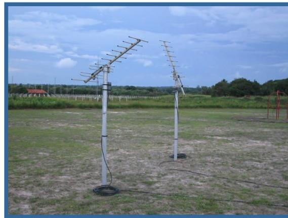
FIGURA 7.1 - Antenas do tipo Yagi do Sistema VHF, instaladas no Observatório Espacial de São Luis – OESLZ/INPE – MCT, São Luis-MA.
