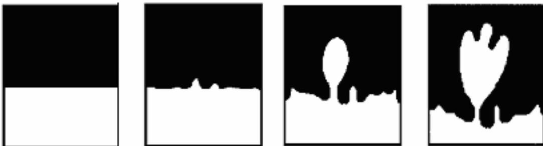
FIGURA 4.3 – Ilustração da Teoria da instabilidade hidrodinâmica RT,
