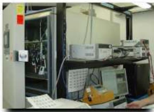
Fig. 5. Sistema de calibração de temperatura e umidade relativa do ar
