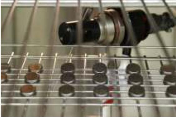
Fig. 6. *iButtons* na câmara climática
