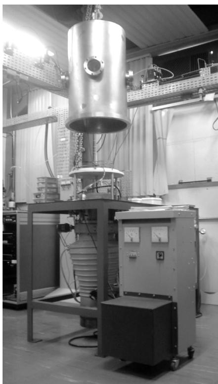
Figura 4. 4- Câmara de deposição dos filmes de DLC por DC pulsado PECVD instalado no Laboratório Associado de Sensores e Materiais (LAS) do Instituto Nacional de Pesquisas Espaciais (INPE).
