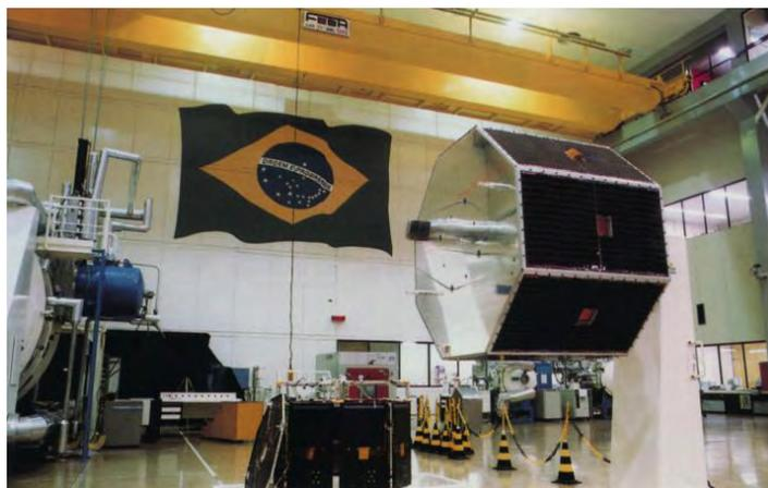
Figura 2.4 - O satélite SCD2 sendo testado no Laboratório de Integração e Testes (LIT) do INPE.
