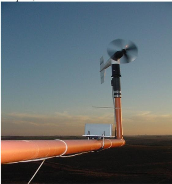
**Figura 7** - Equipamento de medida de dados eólicos da estação SONDA - SMS, instalada no Observatório Espacial do Sul - OES/CRS/CCR/INPE - MCT.
