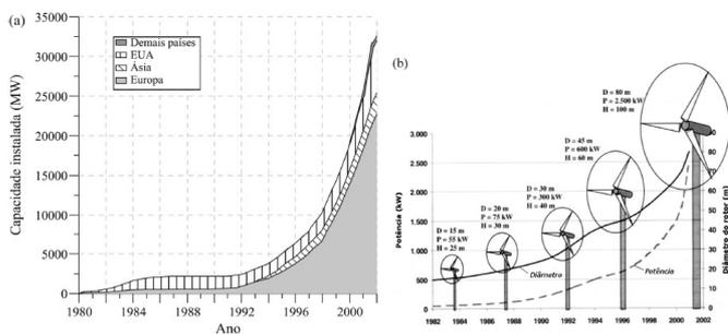
**Figura 4** - (a) Evolução da capacidade instalada de geração eólica de eletricidade no mundo. (b) Evolução tecnológica das turbinas eólicas comerciais (D = diâmetro, P = potência, H = altura) entre 1980 e 2002. Fonte: Gasch e Twele, 2002.
