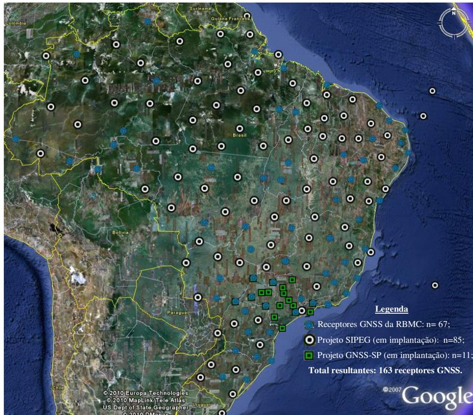
Figura 1 – Configuração da rede GNSS no Brasil depois das densificações em andamento.
