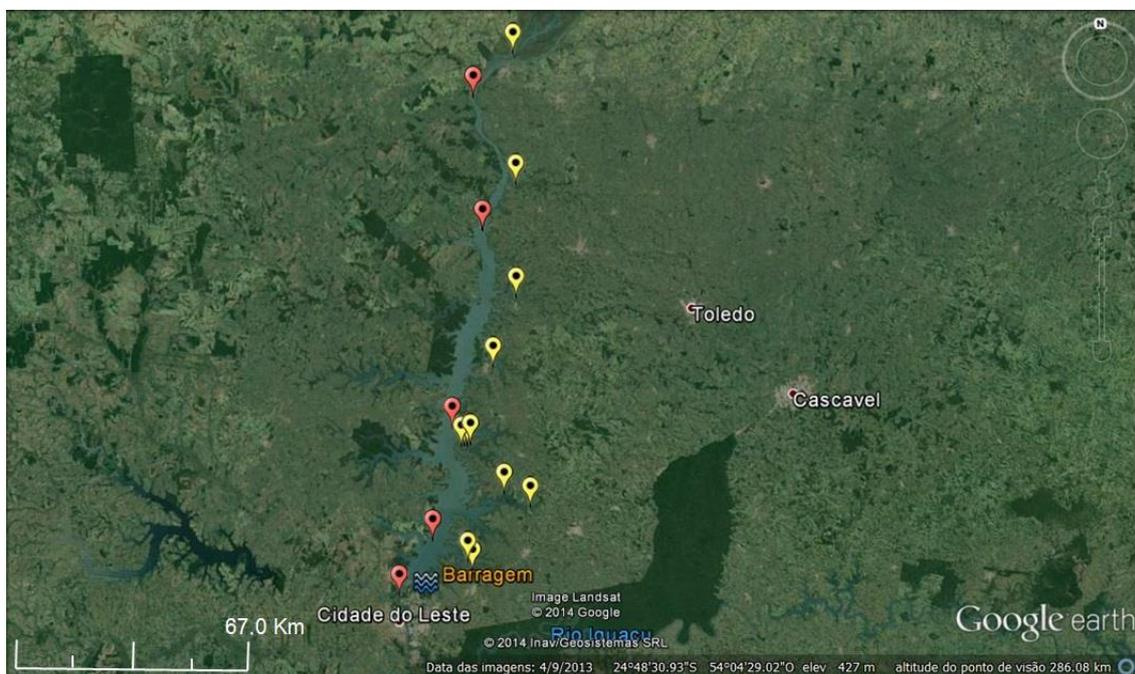
Figura 4.8: Imagem de satélite da área do reservatório da UHE Itaipu e localização dos pontos de amostragem no canal principal (vermelho) e em afluentes (amarelo).
