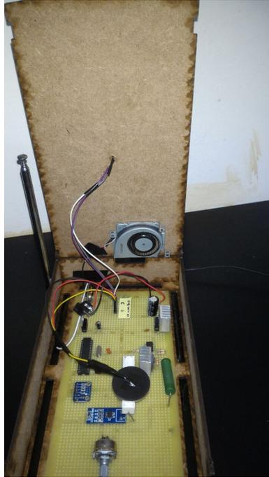
Figura 3.7 - Radiômetro completamente montado com todos os termistores.
