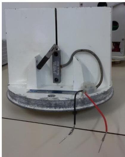
**Figura 6- Pluviômetro SPP-2**
