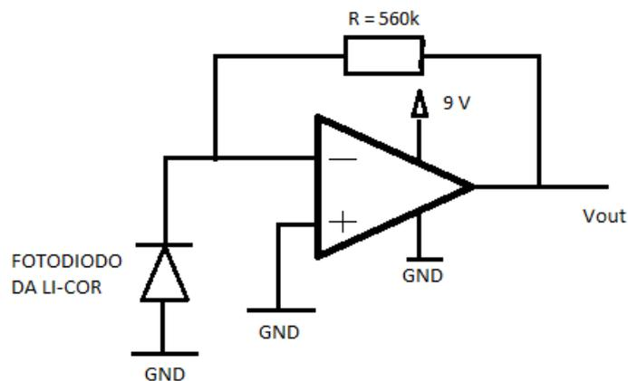
**Figura 5- Projeto do AmpOp para amplificar os sinais de saída do fotodiodo mostrado na figura 4**
