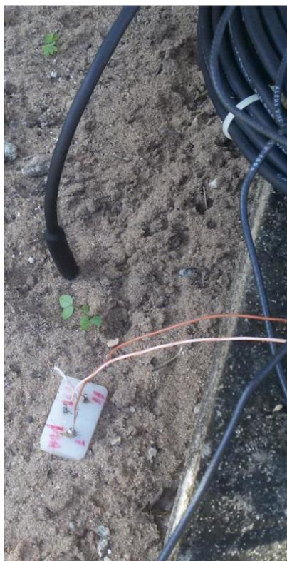
*Figura 17- Sensores de temperatura e umidade do solo*
