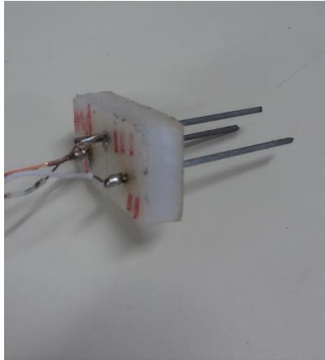
***Figura 8- Sensor de umidade desenvolvido em laboratório***
