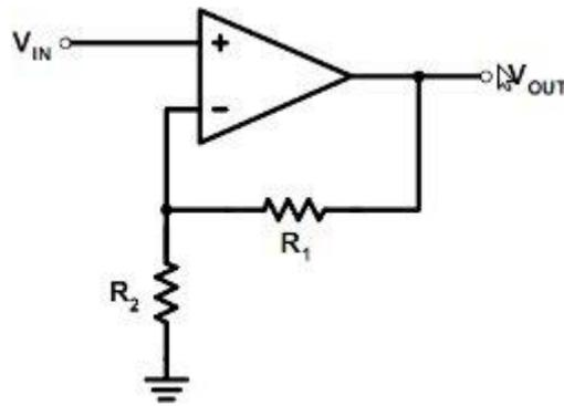
**Figura 3- Projeto do AmpOp utilizado para amplificar os sinais de tensão dos sensors de temperatura**
