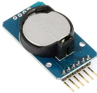
*Figura 11- Módulo RTC*
