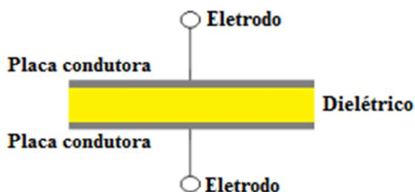
**Figura 2.2.** Desenho esquemático de um elemento sensor do tipo capacitivo.
