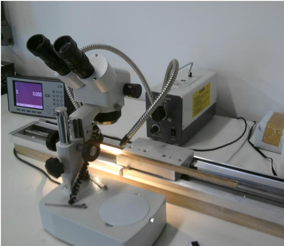
Figura 2. Imagem do estereomicroscópio e da mesa de medição Velmex®
