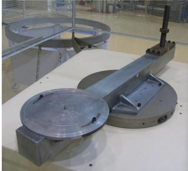
Figura 3.2 - mesa da máquina de balanceamento
