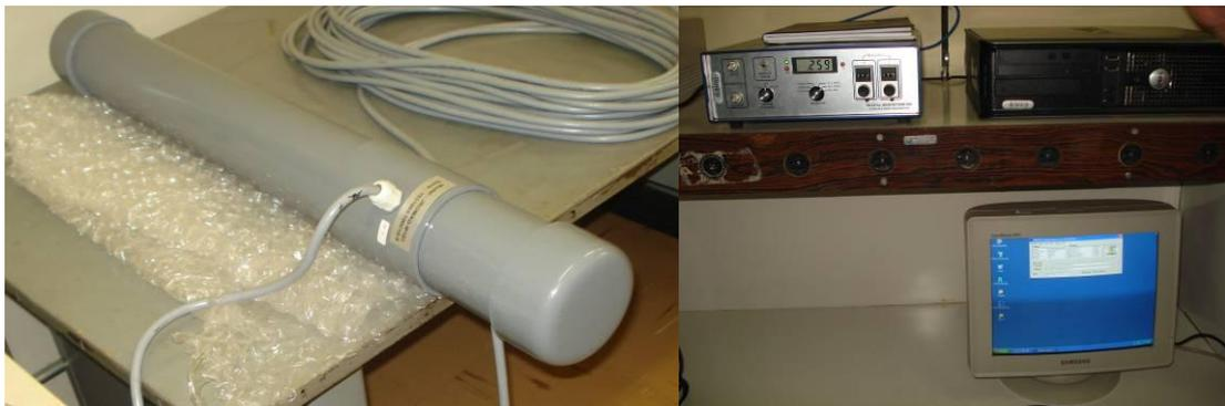
Figura 19: Fotografia de um sistema de magnetômetro utilizado pela Rede EMBRACE, composto por um sensor de variação magnética (à esquerda) e um sistema de aquisição de dados (à direita).
