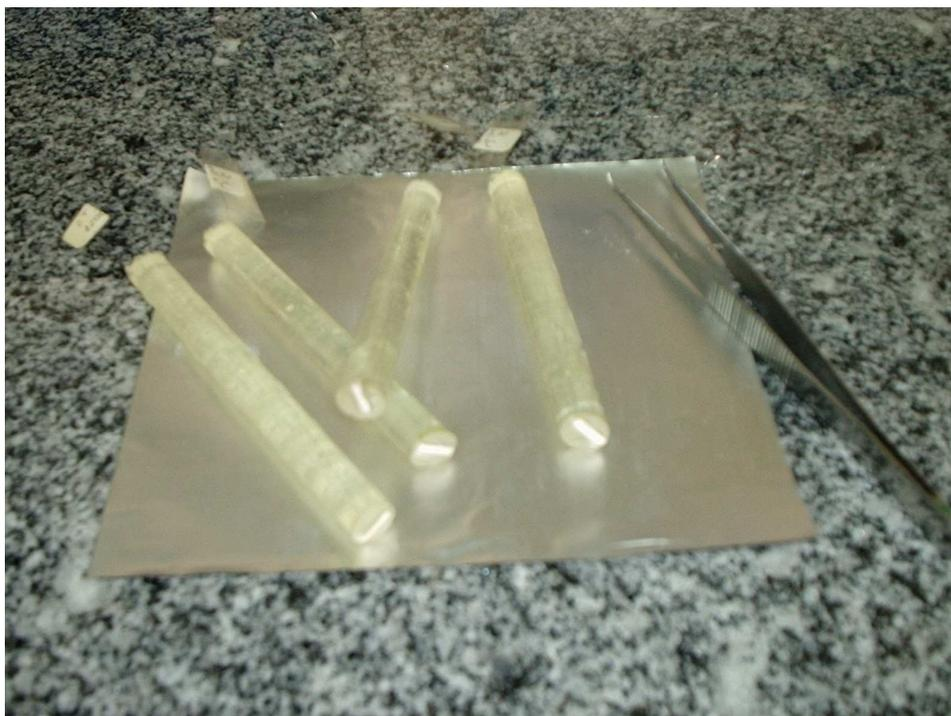
Figura 4. Os elementos sensores cerâmicos de umidade de solo encapsulados com resina epóxi.
