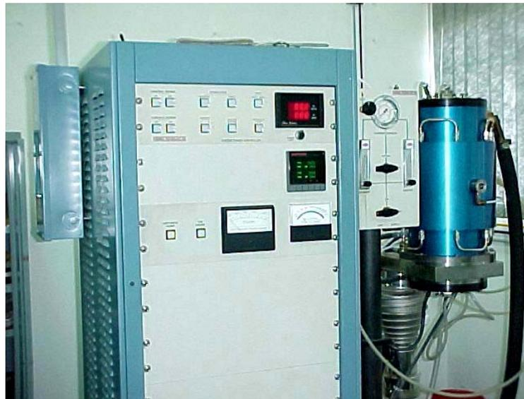
**Fig. 9 – Forno usado para os tratamentos térmicos (Astro, Thermal Engineering)**
