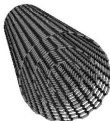
**Fig. 3 – Exemplo de nanotubo de carbono paredes múltipla**
