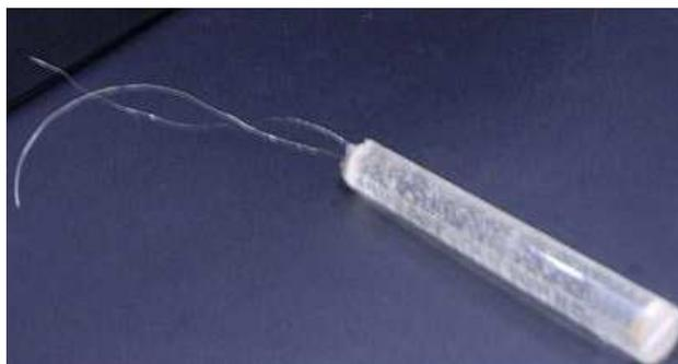
Figura 10. Sensor de umidade de solo.
