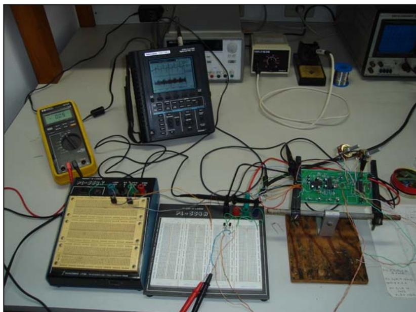
Figura 5.1 – Testes com os transistores 2N2222A e 2N2907A.
