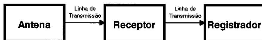
Figura 2.4 - Bloco esquemático de um sistema rádio-receptor para fins de estudos aplicados a Aeronomia.
