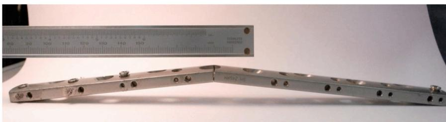
Figura 4 – Vista lateral da placa fraturada.
