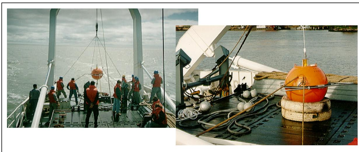
Figura 1 – Detalhes do fundeio do ondógrafo e do instrumento
