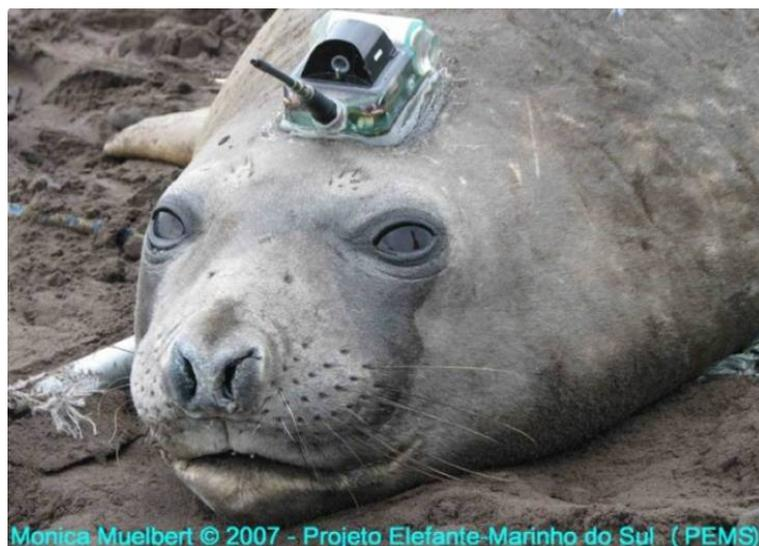
**Figura 2 – Exemplo de PCD utilizada no trabalho fixa em uma fêmea de elefante-marinho do sul. A antena transmissora é facilmente identificada. A pequena caixa preta é o mini-CTD e atrás desse nota-se um elemento cilindro branco que é a caixa de bateria.**
