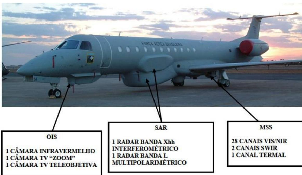
Figura 1. Aeronave R-99 e a localização dos seus sensores aerotransportados. Os sensores SAR e OIS não foram utilizados nessa pesquisa.
