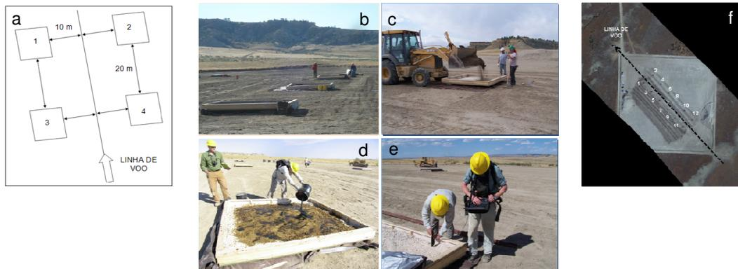
Figura 2. Preparação do macro-experimento de impregnação de substratos com HCs. (a) e (b) organização das caixas de contaminação no campo, (c) adição do substrato argiloso, (d) adição do hidrocarboneto, (e) medição com sensor ultraspectral portátil. (f) Imagem aérea das caixas de contaminação (numeradas de 1 a 12), com indicação da linha de voo de aquisição das imagens hiperespectrais ProSpecTIR V-S.
