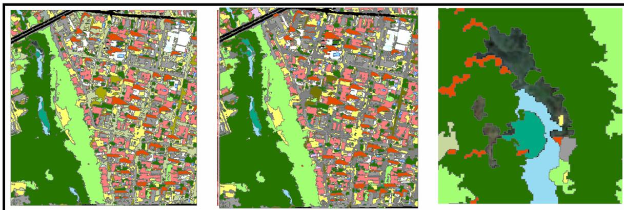
Figura 2. Resultado da Segmentação do software ENVI EX. a) Resultado da Classificação utilizando parâmetro k de 1. b) Resultado da Classificação utilizando o valor de 20 para o parâmetro k. c) Erro na exportação para arquivo shapefile.
