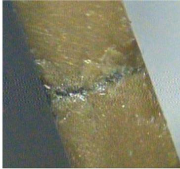
Fig. 6. Canal de *flashover* formado na borda do capacitor 2 durante o teste de BD.
