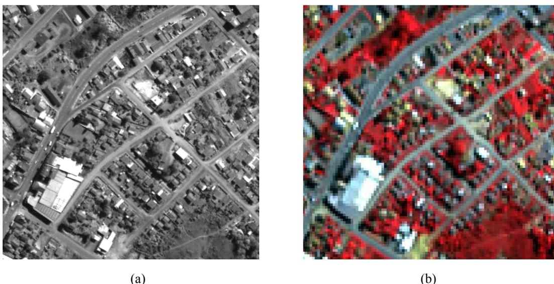
Figura 2 – Recortes imagem IKONOS II – PAN e multiespectral falsa-cor 4R3G2B.
