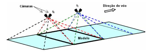
Figura 2: Geometria de aquisição das imagens das câmaras Hasselblad.
