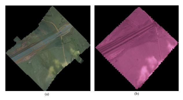
**Figura 5**: Mosaico gerado para a área teste em São José dos Campos: (a) imagens coletadas pela câmara Hasselblad; (a) imagens coletadas pela câmara Sony.
