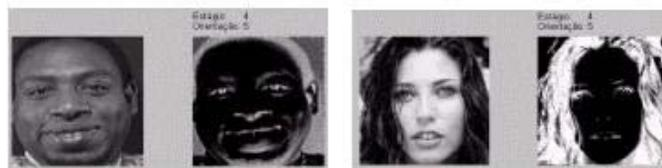
Figura 3: Resultado da aplicação do Filtro Gabor a tons de pele diferentes
