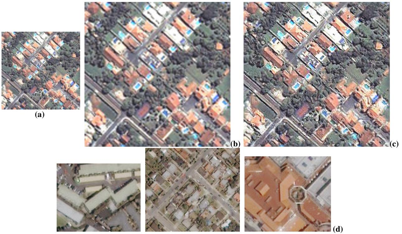
Figura 3. Imagem Ikonos (a) re-amostrada com fator 2 a partir de uma interpolação bi-cúbica (b) e estimada com super-resolução (c) usando amostras de treinamento (d).
