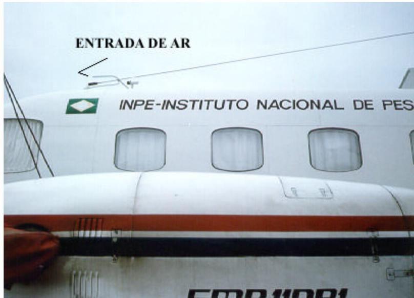
Fig. 3.8 - Entrada de ar externa à aeronave.
