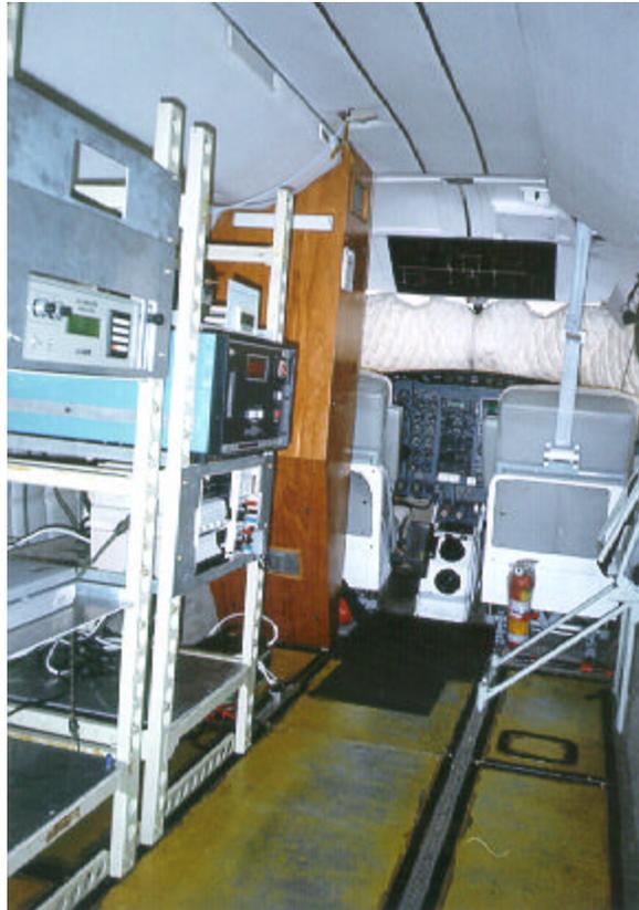
Fig. 3.7 – Vista interna do avião Bandeirante do INPE e do rack instrumentalizado, instalado na aeronave.
