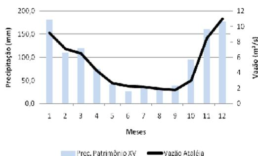
Figura 02 – Variação intra-anual de precipitação em mm e vazão em m<sup>3</sup>/s.
