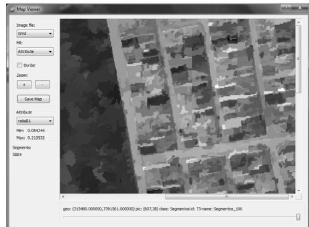
Fig. 5 – Visualização do atributo "razão da banda 1" em níveis de cinza. Os segmentos mais escuros correspondem às classes Solo Exposto e Telha Cerâmica.
