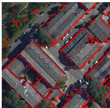
Figura 7-a – Pontos laser definidores de bordas das edificações
