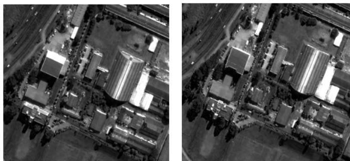
Figura 4- Correção geométrica de imagem Quickbird com a transformação projetiva e dados laser scanner: a) original; v) ortofoto (Araki, 2005).
