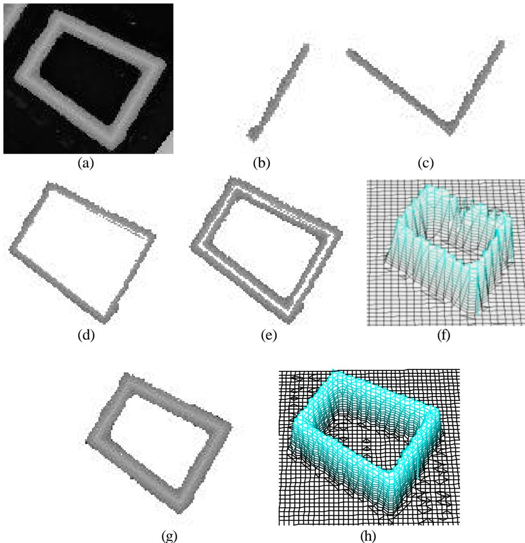
**Figura 8**– (a) Imagem de altimetria de uma edificação com telhado de várias águas; (b) Modelagem de uma das bordas internas da edificação; (c) Modelagem de duas bordas internas; (d) Modelagem externa do telhado; (e) Modelagem do telhado; (f) Modelo da edificação; (g) Resultado melhor da modelagem do telhado; (h) Modelagem 3D da edificação.
