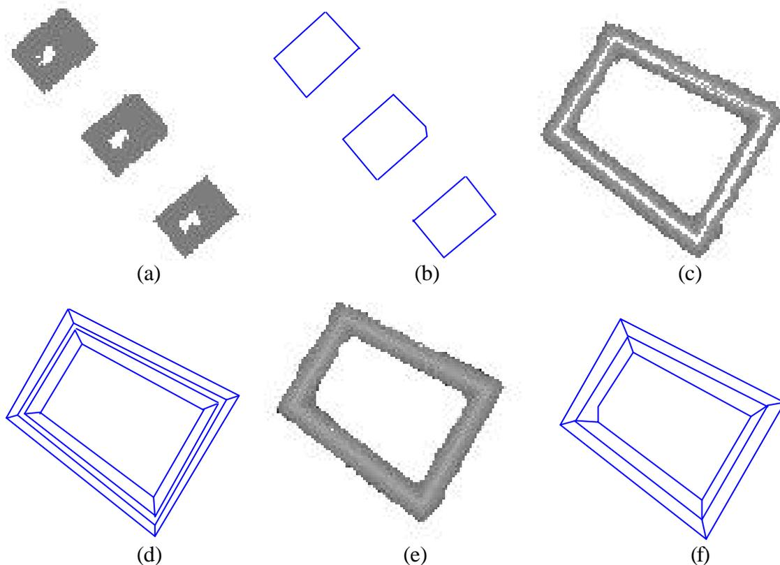
**Figura 9** – (a) Telhados planos segmentados; (b) Reconstrução vetorial do telhado plano; (c) Telhado de várias águas segmentado; (d) Reconstrução vetorial; (e) Segmentação realizada com um limiar maior; (f) Reconstrução vetorial após uma segmentação mais eficiente.
