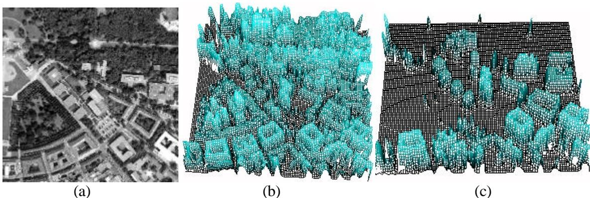
**Figura 1** - (a) Fotografia aérea; (b) Imagem 3D de dados laserscanning do primeiro eco; (c) Imagem 3D do último eco.
