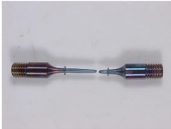
FIGURA 4.3 – Corpo de prova após ruptura em ensaio a 600°C e 250MPa.
