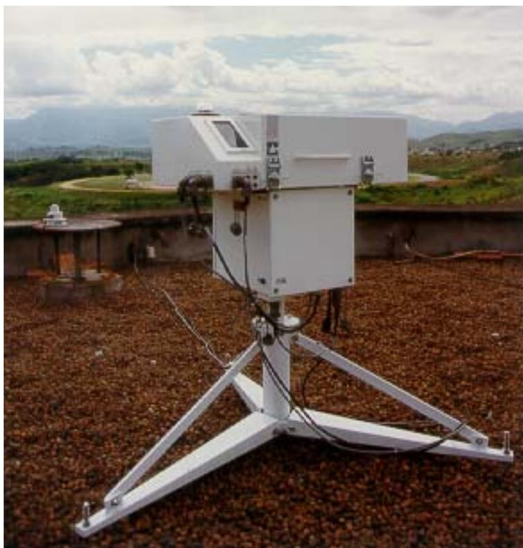
Fig. 1.10 – Espectrofotômetro Brewer numa das estações de medida da radiação UV do Lab. de Ozônio do INPE.
