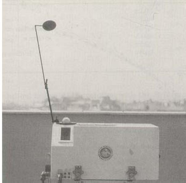
Fig. B.1 - O espectrofotômetro Brewer e o anteparo solar durante uma medida de  $d(\lambda, \theta + \Delta\theta)$ .
