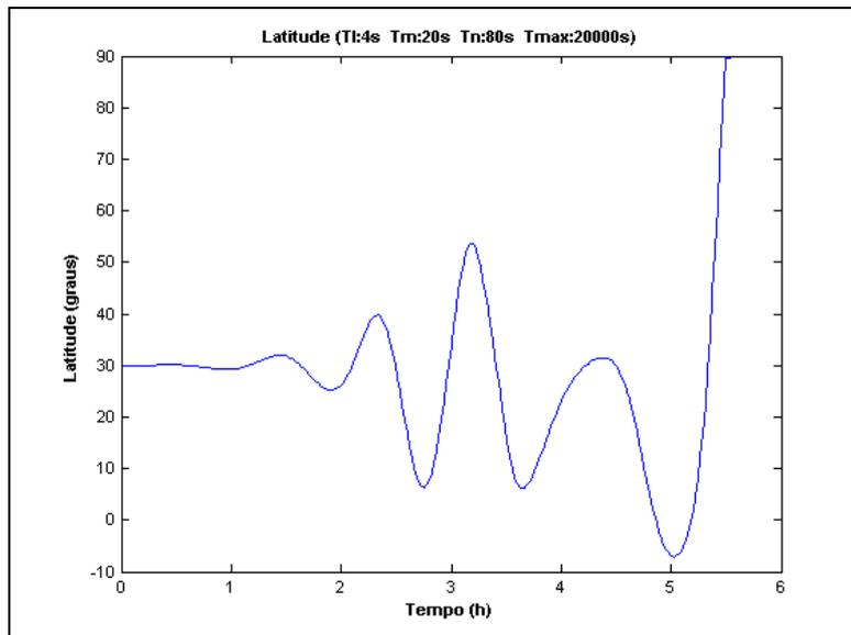
**Figura 3.a** – Comportamento da latitude com condições iniciais Latitude =  $+30^\circ$ , Longitude =  $+40^\circ$  e Altura = 1000m
