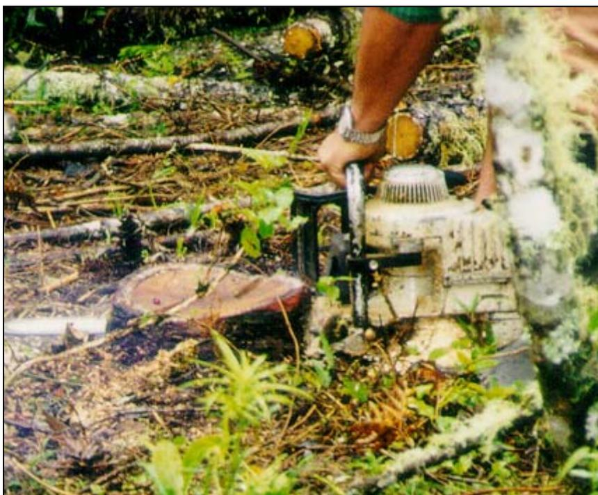
Fig. 3.2 – Obtenção de amostra do restante do tronco que ficou enraizado.
