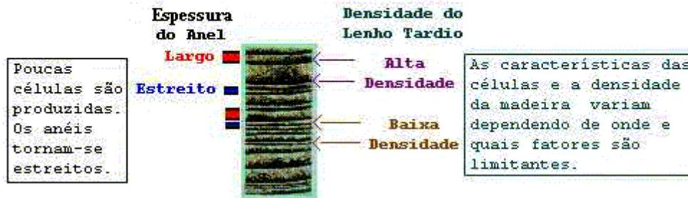
Fig. 2.10 – A figura mostra onde as condições são limitadas nos anéis de crescimento, devido a um ou mais fatores limitantes do crescimento da árvore.
