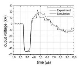
Fig. 5. Pulser output voltage.
