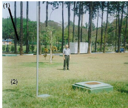
Foto 3 – Visão do local onde foi instalado o marco principal para a sala do Simulador. Pode ser constatada a existência de grande número de obstruções (árvores, cercas e telas)
