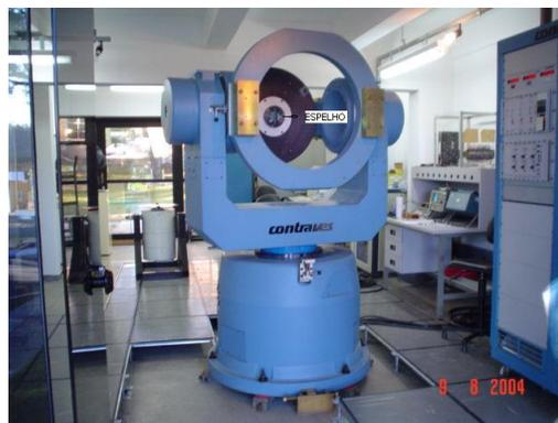
Foto 8: Simulador de Teste de Sensores Inerciais
