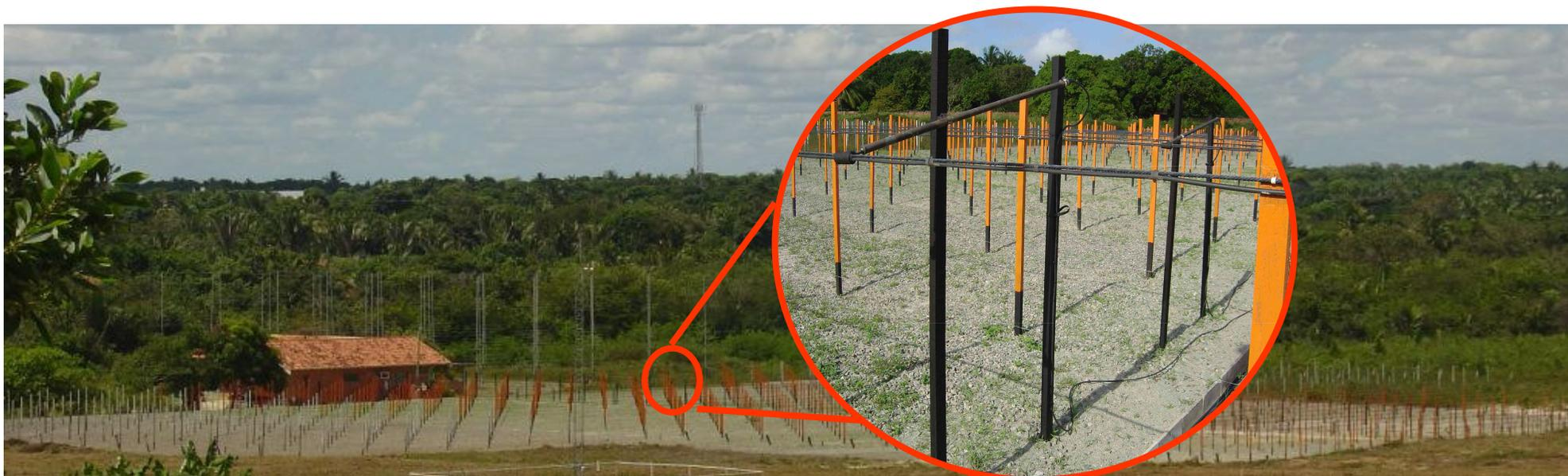
O radar de retro-espalhamento coerente de 50 MHz (RESCO), instalado no Observatório Espacial de São Luís (OESLZ), entrou em operação em agosto de 1998. Ele é capaz de realizar medidas de dinâmica do plasma do eletrojato e de bolhas ionosféricas equatoriais. Este radar foi projetado para mapear a turbulência e a deriva eletromagnética das irregularidades de curta escala de comprimento (3m) numa faixa de altura que se estende de 90 km até 1000 km.
