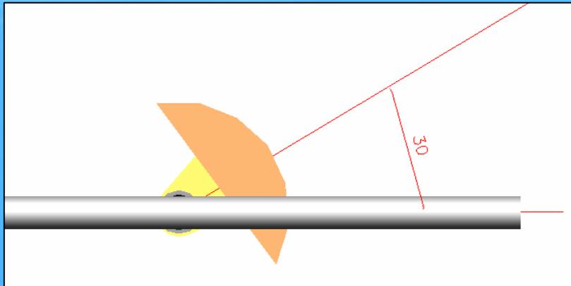
O suporte da coroa de declinação é soldada com um ângulo de  $30^\circ$  com a estrutura H.
