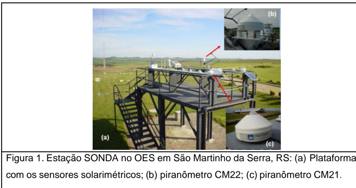
Figura 1. Estação SONDA no OES em São Martinho da Serra, RS: (a) Plataforma com os sensores solarimétricos; (b) piranômetro CM22; (c) piranômetro CM21.
