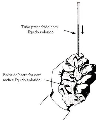
FIGURA 2.2 - Demonstração do princípio da dilatância de Reynolds. Uma bolsa de borracha é preenchida com areia grossa e um líquido colorido. Um fino tubo de vidro, que também contém este líquido é inserido na bolsa. Observa-se que o nível de líquido no tubo diminui quando a bolsa é apertada.
