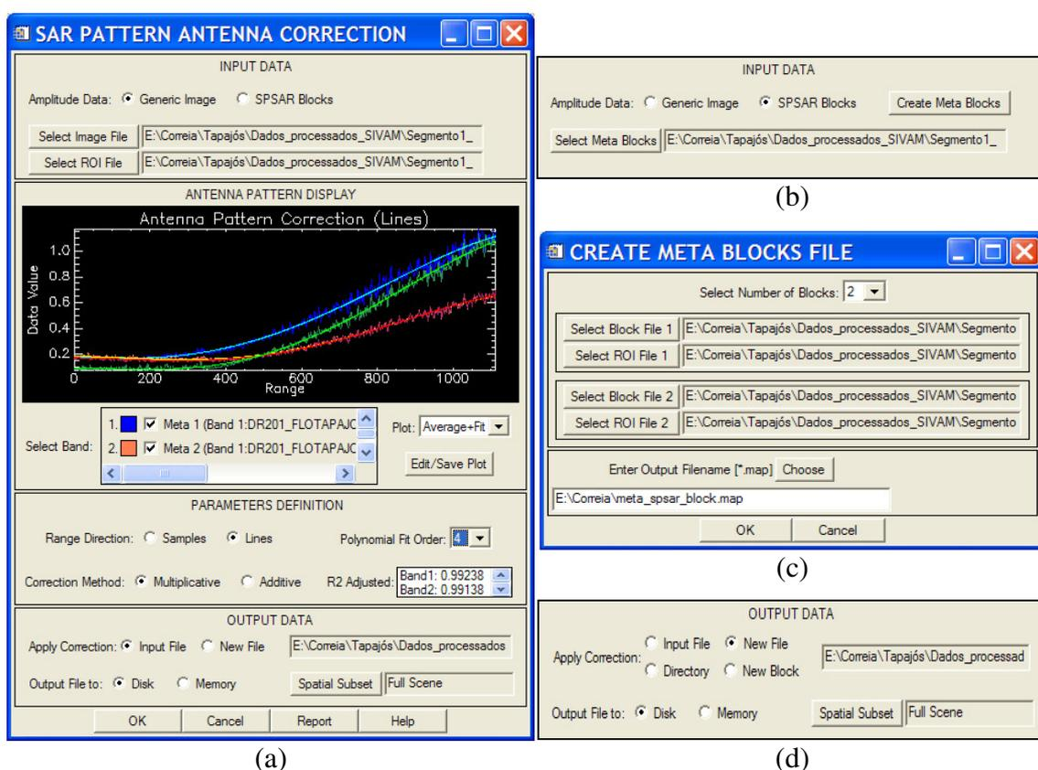
Figura B.9 – Interfaces para correção do padrão da antena: (a) principal, (b) seleção do arquivo *Meta Blocks*, (c) criação do arquivo *Meta Blocks*, e (d) seleção dos blocos de saída.
