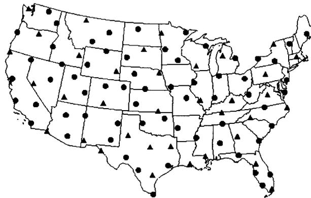
Figura 4.1 - Localização dos sensores da NLDN. Triângulos representam sensores IMPACT e círculos representam LPATS.
